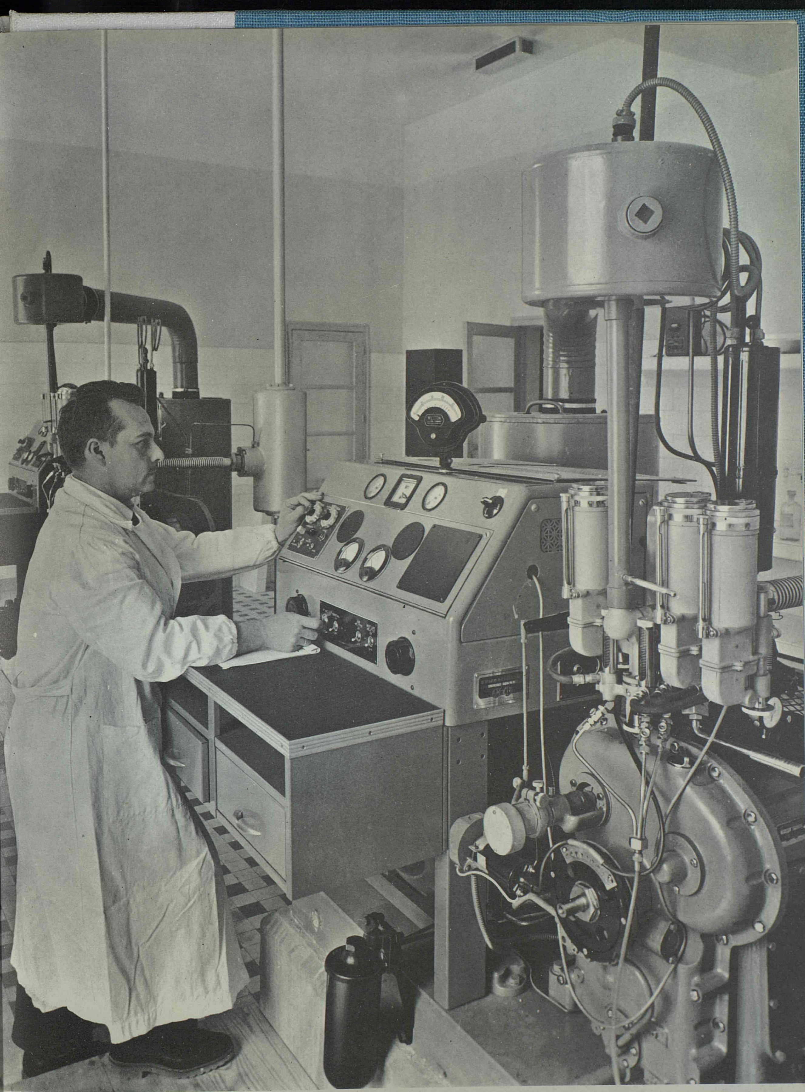
Determinación del índice de octano en las gasolinas. Sala de motores en Madrid.
