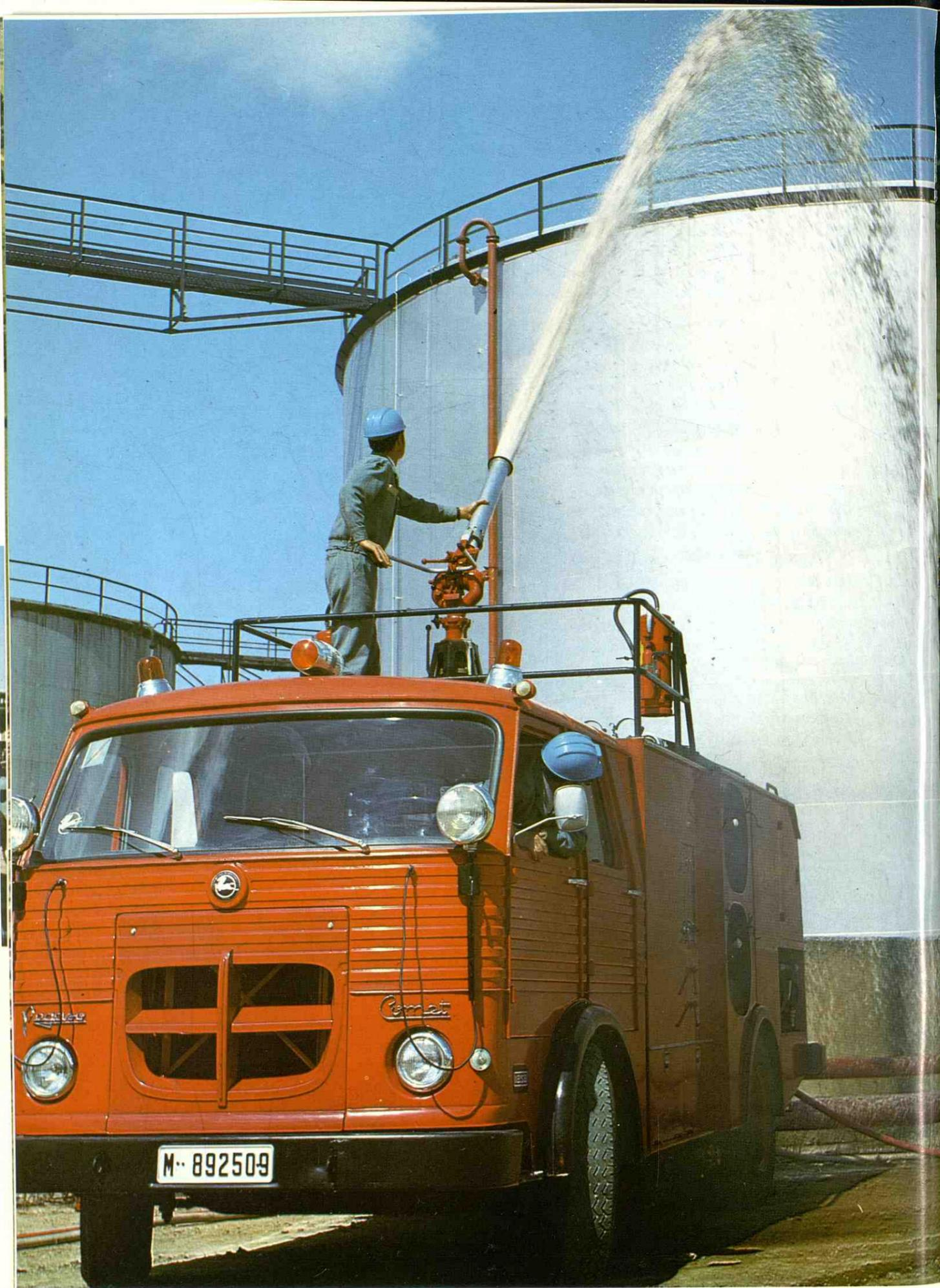
Camión contra-incendios en prácticas de lanzamiento de espuma sobre un tanque.
